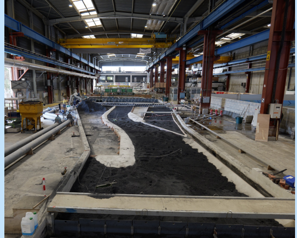
L'Artelia, laboratoire de modélisation physique pour dimensionner et sécuriser les ouvrages hydrauliques, chez Artelia - © Artelia
